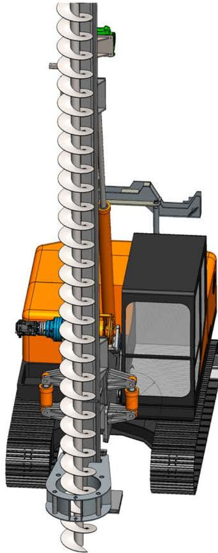
SISTEMA COM DOIS PISTÕES DE NIVELAMENTO EXCLUSIVO PARA MELHOR ESTABILIDADE DE NIVELAMENTO
